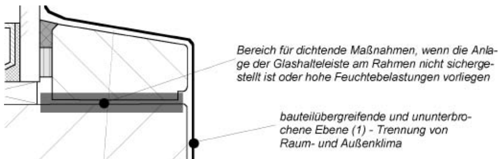
Bild 5: Ebenenmodell im Bereich Glashalteleiste und Rahmen
