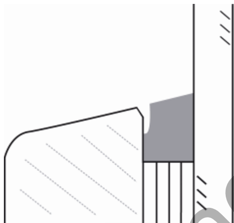
Bild 18: Haftverlust des Dichtstoffs durch mangelhafte Untergrundvorbehandlung oder Unverträglichkeit mit der Beschichtung (Adhäsionsverlust)
