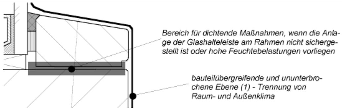
Bild 5: Ebenenmodell im Bereich Glashalteleiste und Rahmen
