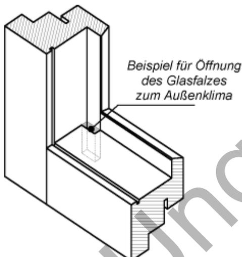
Bild 2: Dampfdruckausgleich nach außen über Öffnungen
