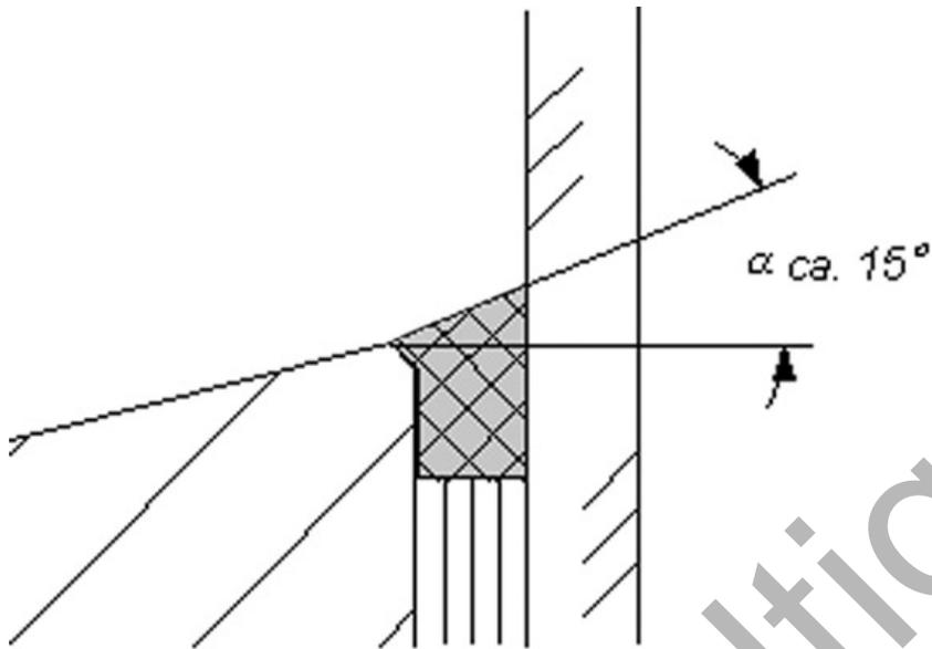
Bild 10 Dichtstoffgeometrie der Versiegelung
