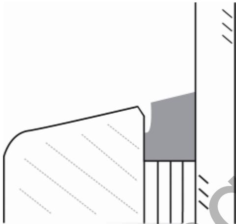
Bild 18: Haftverlust des Dichtstoffes durch mangelhafte Untergrundvorbehandlung oder Unverträglichkeit mit der Beschichtung (Adhäsionsverlust)
