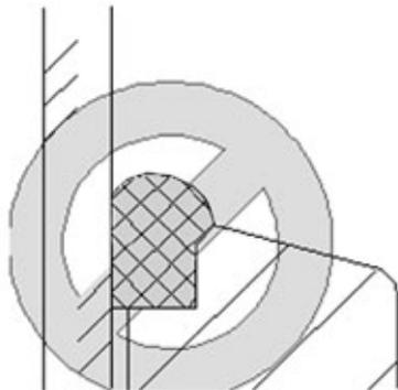
Bild 13: Fehlerhafte Ausführungen der Versiegelung
