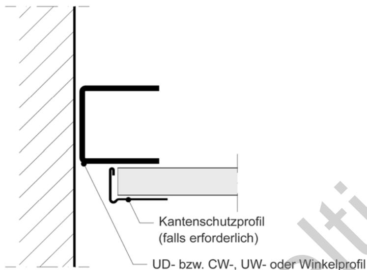
Abbildung 1: Anschluss abgehängte Decke zur Wand, konstruktiv
