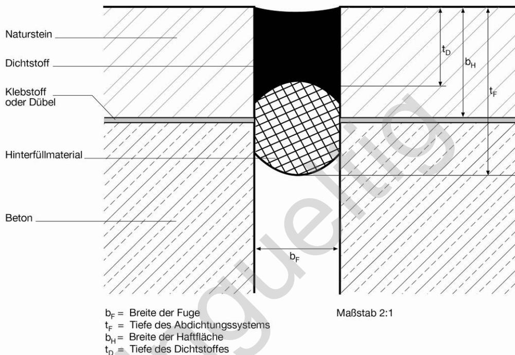
Abbildung 7: Bauteilfuge
