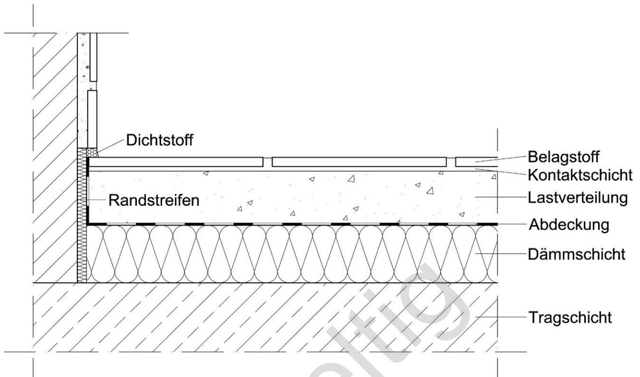
Abbildung 8: Anschlussfugen Wand/Boden
