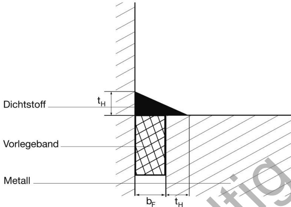
Abbildung 9: Prinzipskizze zur Eck-Fugenbemessung
