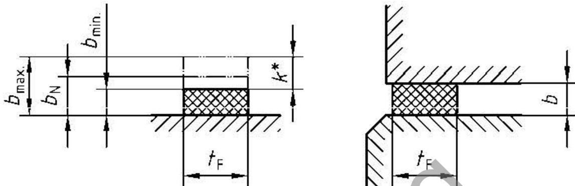
Abbildung 14: Geometrie Kompriband-Anwendung
