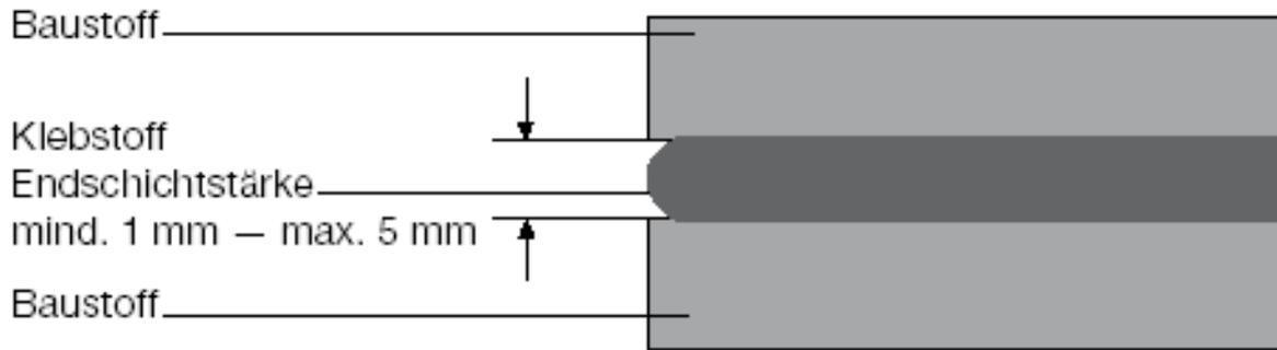
Abbildung 13: Endschichtstärke von elastischen Montageklebstoffen
