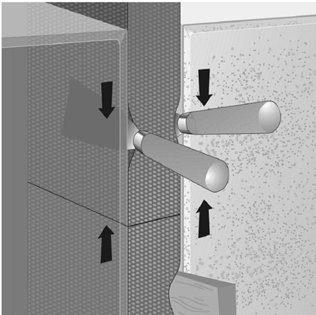
Abbildung 16: Fugenkreuzungen nachträglich mit Dichtband schließen
