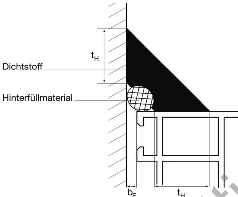
Abbildung 10: Prinzipskizze zur Eck-Fugenbemessung
