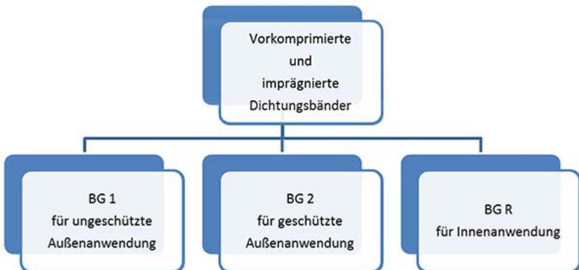
Abbildung 8: Vorkomprimierte und imprägnierte Dichtungsbänder aus Schaumkunststoff
