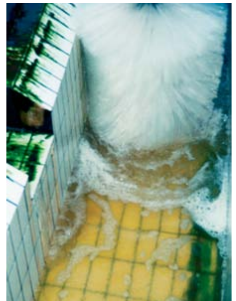
Die Keramikverfugung mit einem Spezial-Fugenmörtel besitzt eine hohe Widerstandsfähigkeit gegenüber mechanischen Belastungen.
